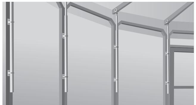
Für erhöhte Windlasten (bis zu 160 km/h) ist der Schirm durch die optionalen Sprossenabstützungen zu sichern. Diese verbinden die Schirmsprossen mit den Windschutzwänden und stabilisieren somit die gesamte Konstruktion. Bei aufkommendem Wind bzw. bei Verlassen der Anlage ist der Schirm in dieser Form zu sichern.
