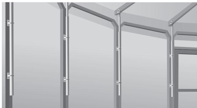
En cas d'exposition à des vents violents (jusqu'à 160 km/h), le parasol doit être sécurisé au moyen de renforts de baleines disponibles en option. Ces accessoires relient les baleines aux paravents de manière à stabiliser l'ensemble de la structure. Le parasol doit être sécurisé ainsi dès lors que le vent se lève ou que vous quittez l'installation.
