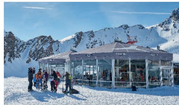
Die Gletschermühle am Kitzsteinhorn nutzt die Sonderschirme mit spezieller Windschutzverglasung und direktem Gebäudeanschluss als Restaurantweiterung
