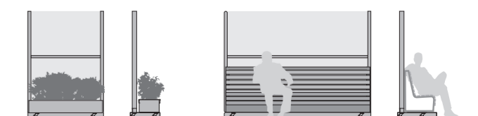
Windschutzwände ohne fixe Verankerung: Das Gewicht von Blumentrögen bzw. Sitzbänken ist für einen sicheren Halt konzipiert. Wind protection walls without fixed anchoring: The weight of flowerpots or benches are designed to hold the structures down.
